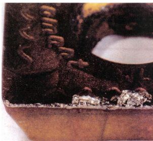
Şekil 3.35. Kesici kenarda oluşan BUE .
