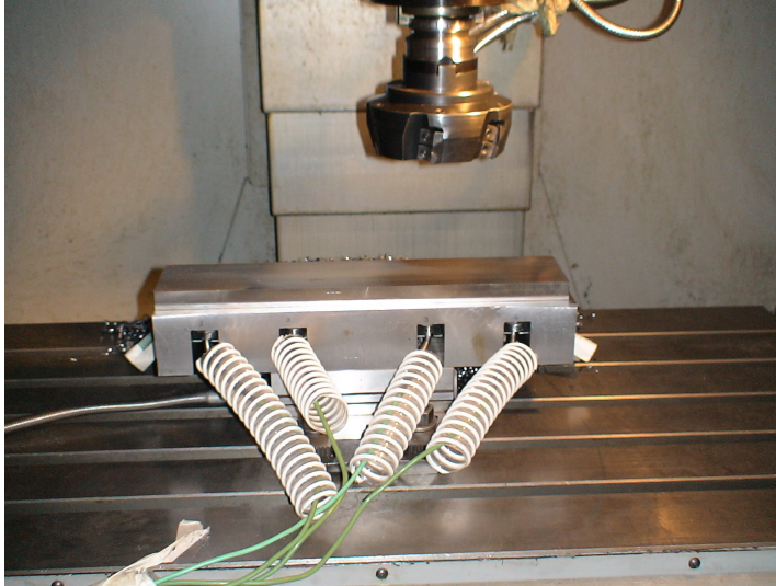
Şekil 4.5. Kuvvet ölçer, kalıp ve iş parçası.
