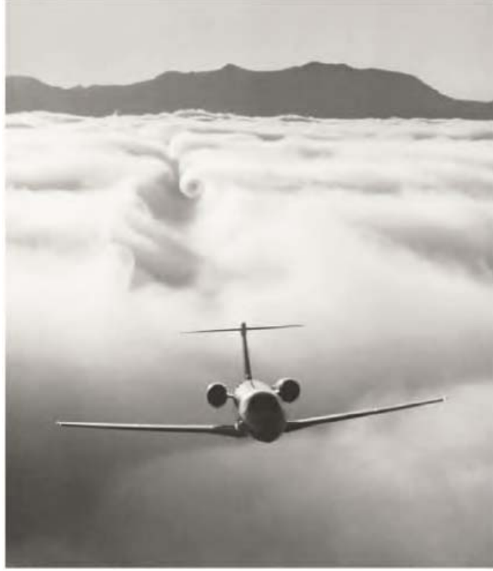
Şekil. 2.19 Kanat Ucu Girdapları [Anderson and Eberhandt, 2001].
