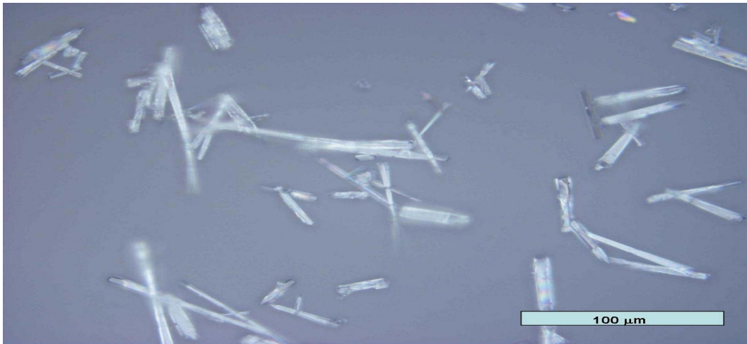
Resim 3.1: 500 X büyütmede gözlemlenen müllit tanecikleri
