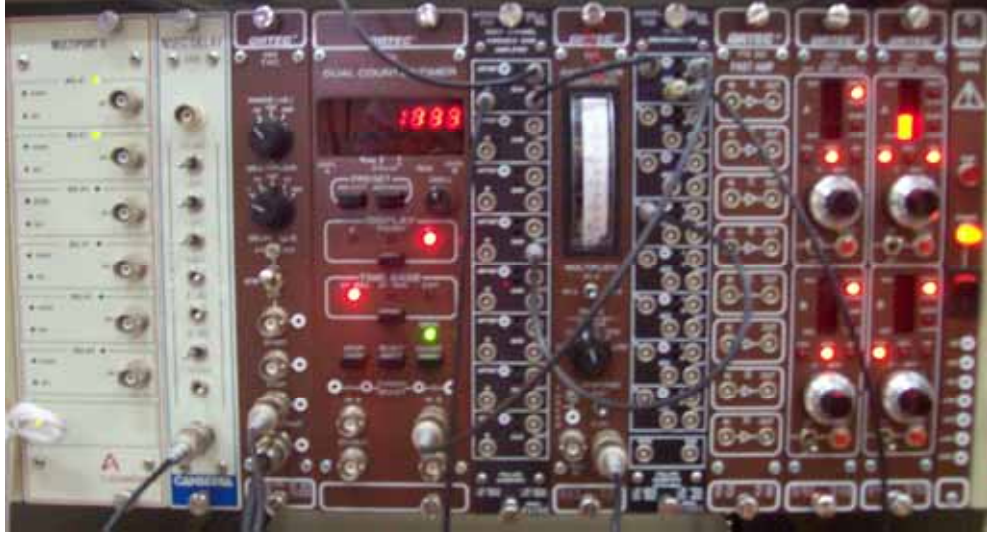
Şekil 3. 13: Afyon Kocatepe Üniversitesi (e-2e) elektron spektrometresinde kullanılan sinyal işleme birimleri deneysel dizaynı.
