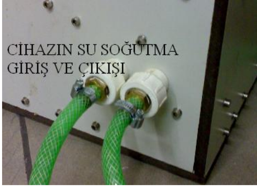
Şekil V.20 Sistemin soğutma suyu giriş-çıkışı
