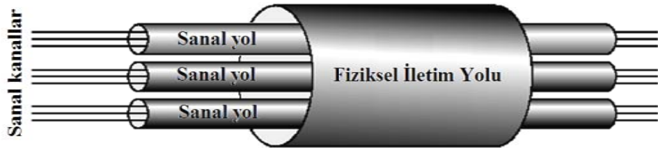
Şekil 2.9: ATM’de kullanılan sanal yollar ve sanal kanallar.
