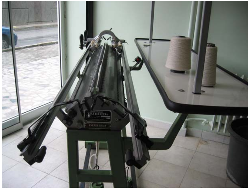
Şekil III.2.8. Duibed marka Düz örme makinesi [78]
