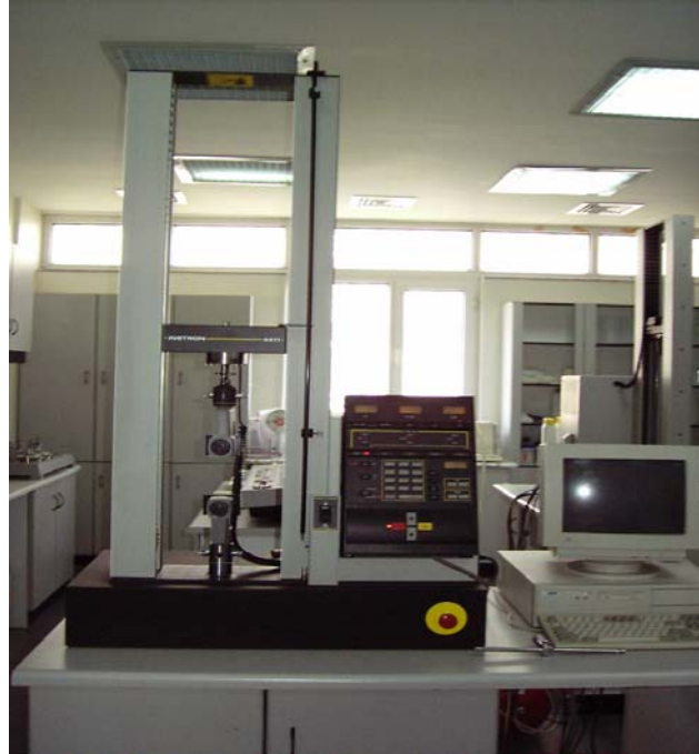
Şekil III.2.6. Instron Marka 4411 Model Mukavemet Ölçüm Cihazı
