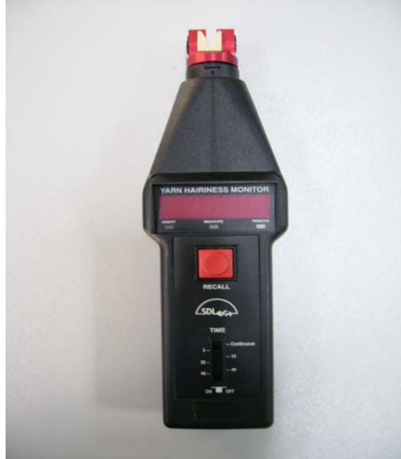
Şekil III.2.7. Shirley Tüylülük Ölçüm Cihazı
