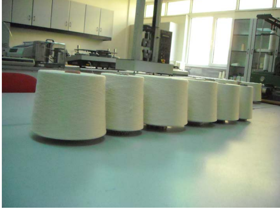
Şekil III.2.1. Çalışmada Kullanılan İplikler, Sırasıyla: Ne 24, Ne 20, Ne 28, Ne 30, Ne 33, Ne 40.
