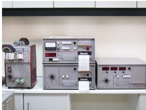
Şekil III.2.5. Düzgünsüzlük Ölçümlerinde Kullanılan Uster Tester I Cihazı
