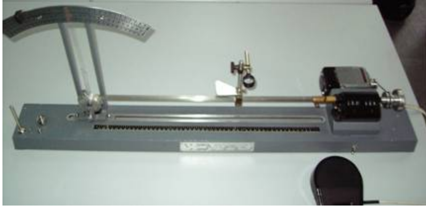
Şekil III.2.4. James H. And Heal İplik Büküm Cihazı
