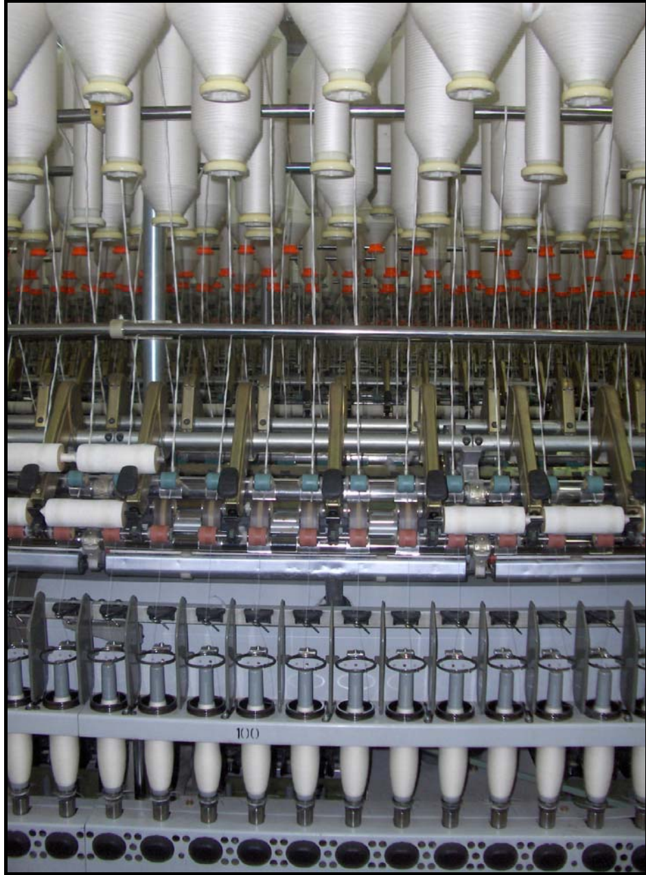
Şekil III.2.1. Ring iplik işletmesindeki ring makinesinin önden görünüşü.
