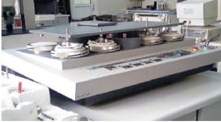
Şekil III.2.11 NU-Martindale Aşınma ve Boncuklanma Test Cihazı
