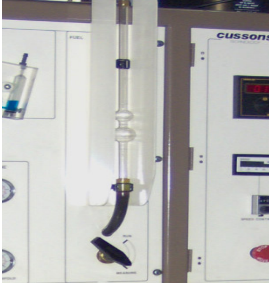
Şekil III.4 Yakıt Tüketimi Ölçme Düzeneği
