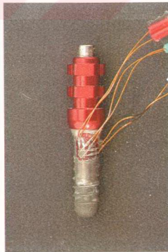
Şekil 3.3. Yüzeyi hazırlandıktan sonra rozet strain gauge yapıştırılmış implant.
