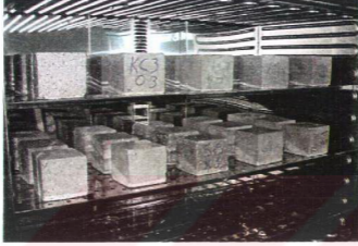
Şekil 4.14. Etüvde kurutulan beton örnekler
