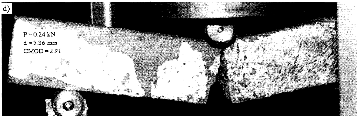
Şekil 6.5 % 4.5 çelik tel takviyeli ve a = 20 \text{ mm} çentik derinliğindeki numunenin eğme testi esnasındaki çatlak büyüme davranışı
