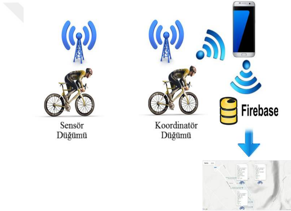
Şekil 3.31: Sensör verilerinin internet sayfasına aktarılmasını gösteren blok diyagramı.
