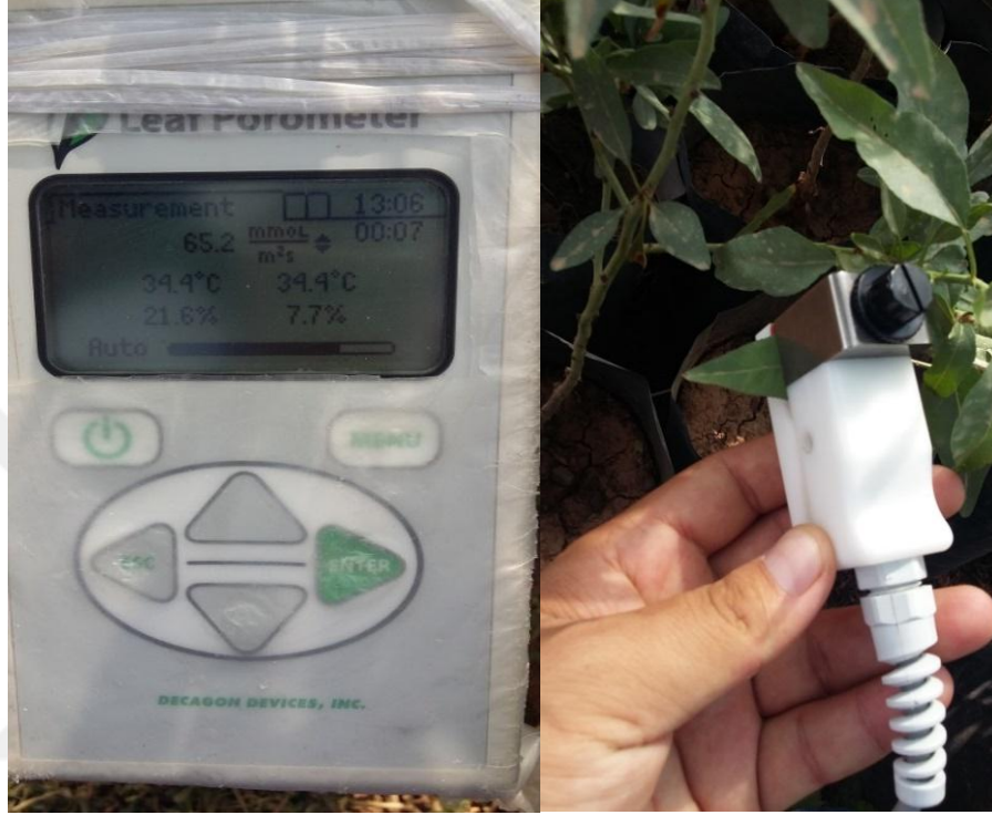
Şekil 3.23. Bitkilerdeki yaprakların yaprak porometresi ile stoma iletkenliğinin ölçülmesi
