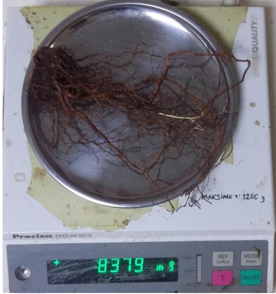
Şekil 3.21. Bitkilerde kök kuru ağırlığının hassas terazi ile belirlenmesi
