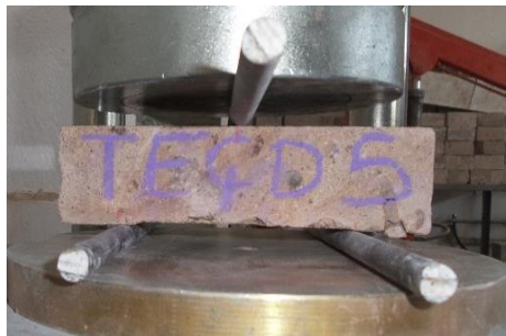
Şekil 3.2. Yığma birimlerin eğilmede çekme dayanımı testleri (TEÇD-1/TEÇD-6 numuneleri).
