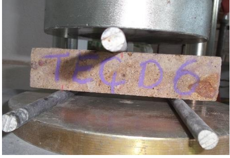
Şekil 3.2 (devam). Yığma birimlerin eğilmede çekme dayanımı testleri (TEÇD-1 /TEÇD-6 numuneleri).
