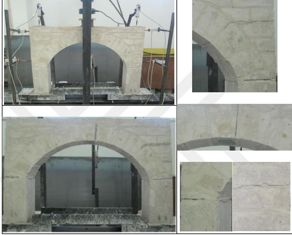
Şekil 4.8. Referans numunenin deney öncesi, sonrası görünümü ve çatlak detayları.
