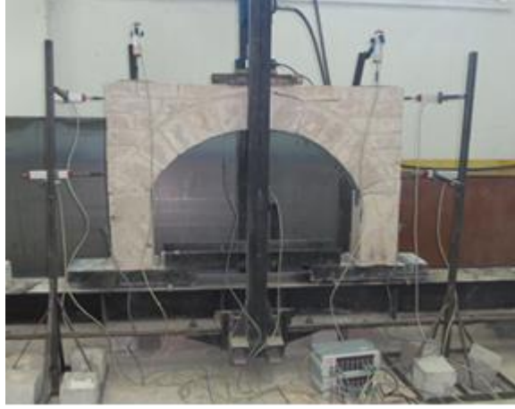
Şekil 4.4. Deney numunelerine strain-gaugelerin yerleştirilmesi.
