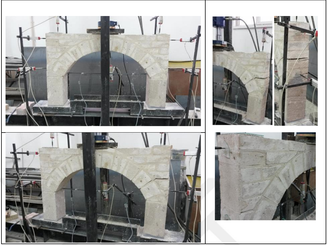
Şekil 4.32. Numune 6 deney numunesinin deney öncesi, sonrası görünümü ve çatlak detayları.
