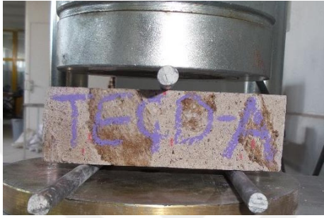
Şekil 3.2 (devam). Yığma birimlerin eğilmede çekme dayanımı testleri (TEÇD-1 /TEÇD-6 numuneleri).
