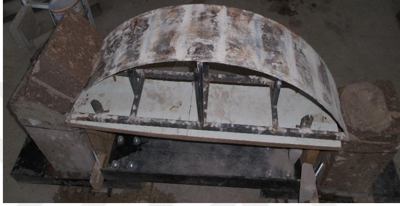
Şekil 4.6. Kemer örümünde kullanılan kemer kalıbı.
