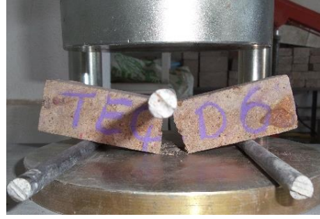
Şekil 3.2 (devam). Yığma birimlerin eğilmede çekme dayanımı testleri (TEÇD-1 /TEÇD-6 numuneleri).
