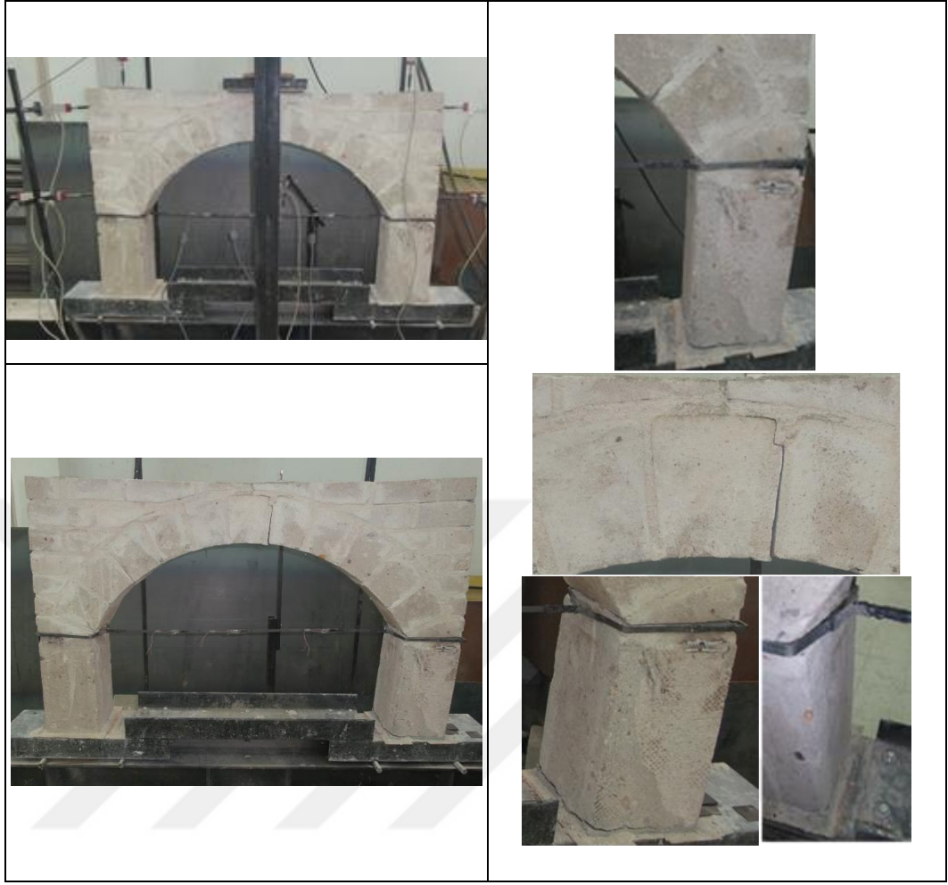
Şekil 4.26. Numune 4 deney numunesinin deney öncesi, sonrası görünümü ve çatlak detayları.
