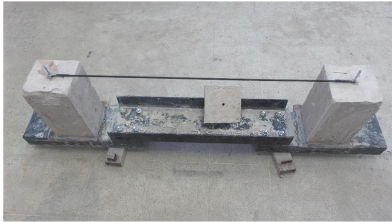
řekil 4.11. Numunede kullanılan gergi çubuęu.
