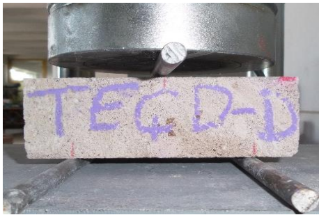
Şekil 3.3. Yığma birimlerin eğilmede çekme dayanımı testleri (TEÇD-A/TEÇD-F numuneleri).
