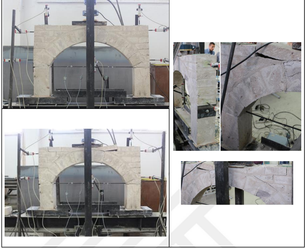
Şekil 4.18. Numune 2 deney numunesinin deney öncesi, sonrası görünümü ve çatlak detayları.
