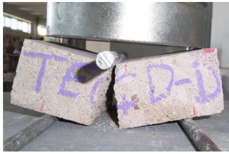
Şekil 3.3. Yığma birimlerin eğilmede çekme dayanımı testleri (TEÇD-A/TEÇD-F numuneleri).
