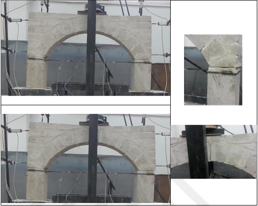
Şekil 4.23. Numune 3 deney numunesinin deney öncesi, sonrası görünümü ve çatlak detayları.
