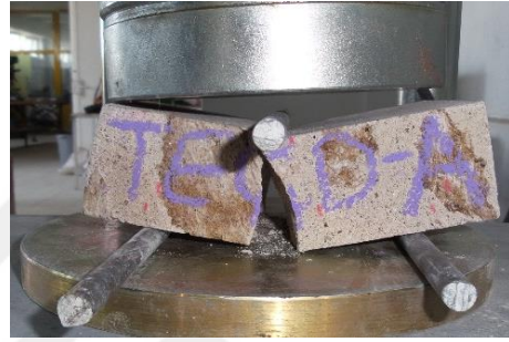
Şekil 3.2 (devam). Yığma birimlerin eğilmede çekme dayanımı testleri (TEÇD-1 /TEÇD-6 numuneleri).
