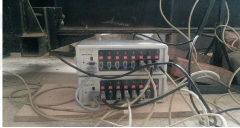
Şekil 4.5. Deney düzeneğindeki yük hücresinin, strain-gaugelerin ve LVDT’lerin veri toplama ünitesine bağlanması.
