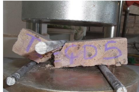
Şekil 3.2. Yığma birimlerin eğilmede çekme dayanımı testleri (TEÇD-1/TEÇD-6 numuneleri).
