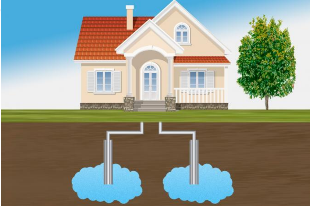
Şekil 4.9. Açık Çevrim Toprak Kaynaklı Isı Pompası
