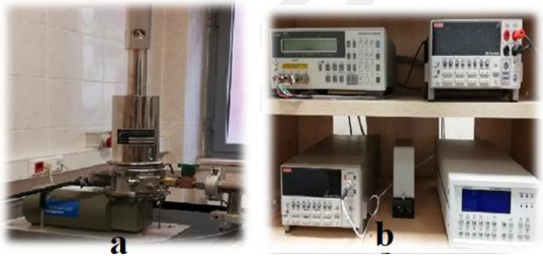
Şekil 3.4: Paulownia tomentosa ekstraktlarının elektriksel ölçümlerinin yapıldığı ölçüm cihazları (a:Cryostat cihazı, b: Elektriksel iletim ölçüm cihazı)
