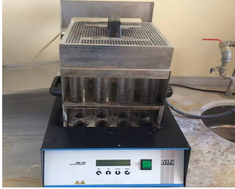
Şekil 3.4. Ağaç yapraklarının ham protein analizinde kullanılan yaş yakma ünitesi
