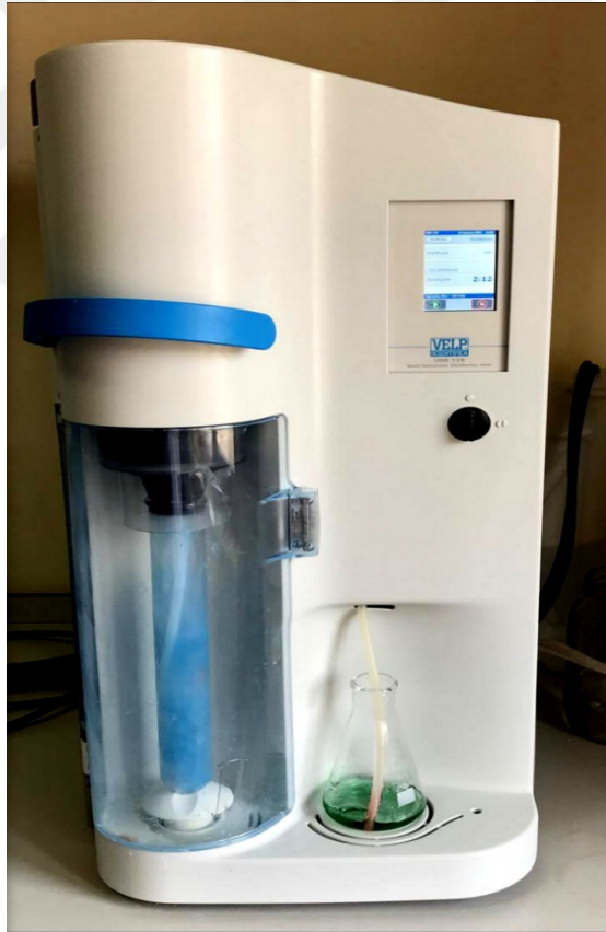
Şekil 3.5. Ağaç yapraklarının ham protein analizinde kullanılan destilasyon ünitesi
