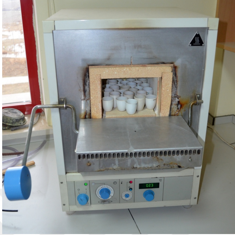
Şekil 3.2. Ağaç yapraklarının ham kül içeriklerinin belirlenmesinde kullanılan kül fırını
