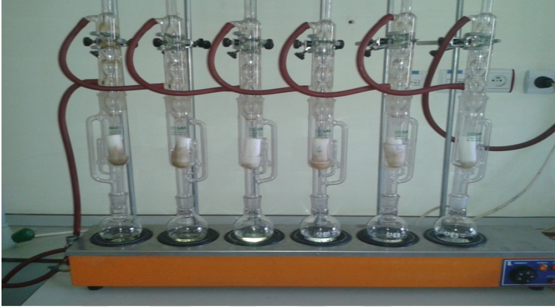
Şekil 3.3. Ağaç yapraklarının ham yağ içeriklerinin belirlenmesinde kullanılan Soxhlet cihazı
