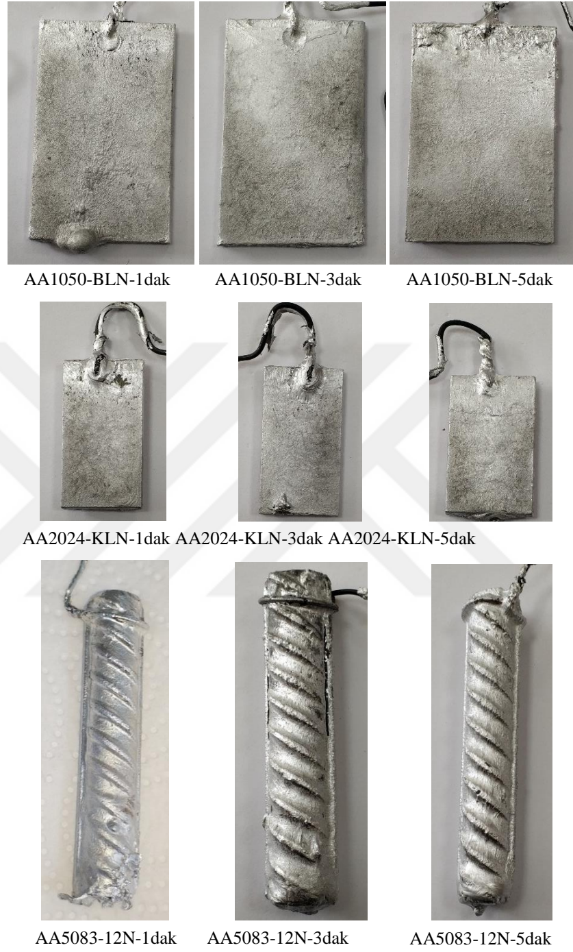
Şekil 3.5. Farklı AA'lar ile kaplanmış çelikler
