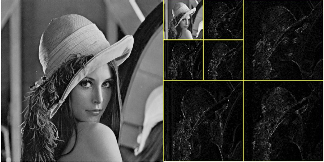
Şekil 2.8 : Görüntünün 2. dereceden DWT dönüşümü
