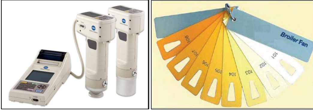
Şekil 2.2. Renk Ölçüm Cihazı (Konica-Minolta) ve Etlik Piliç Renk Skalası
