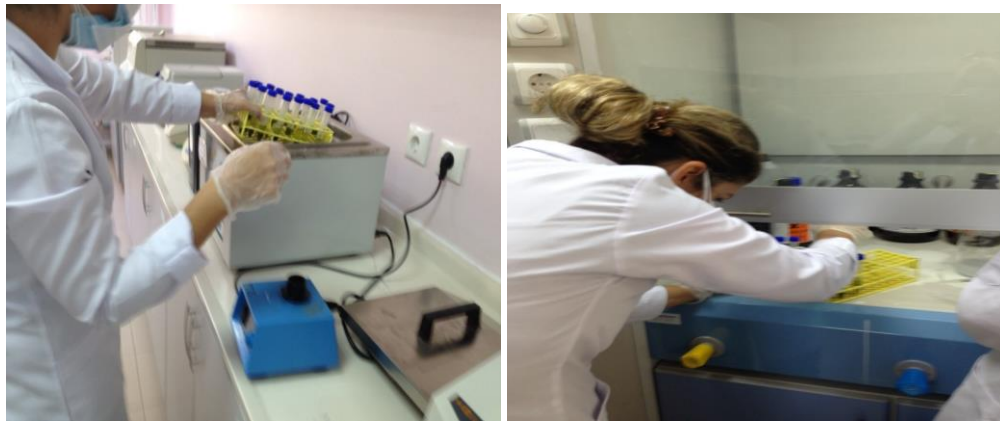
Şekil 4.2. Yaprak örneklerinin ekstraksiyon sırasında su banyosunda bekletme ve fenol kloroform/ isoamyl alkol ekleme aşaması
