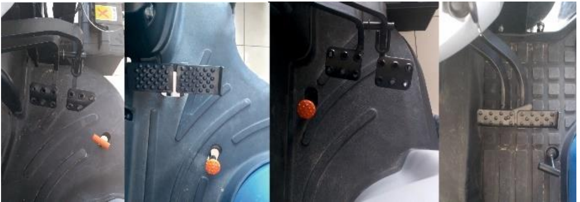
Şekil 4.3. TRA traktörlerine ait gaz ve fren pedalları yerleşimi
