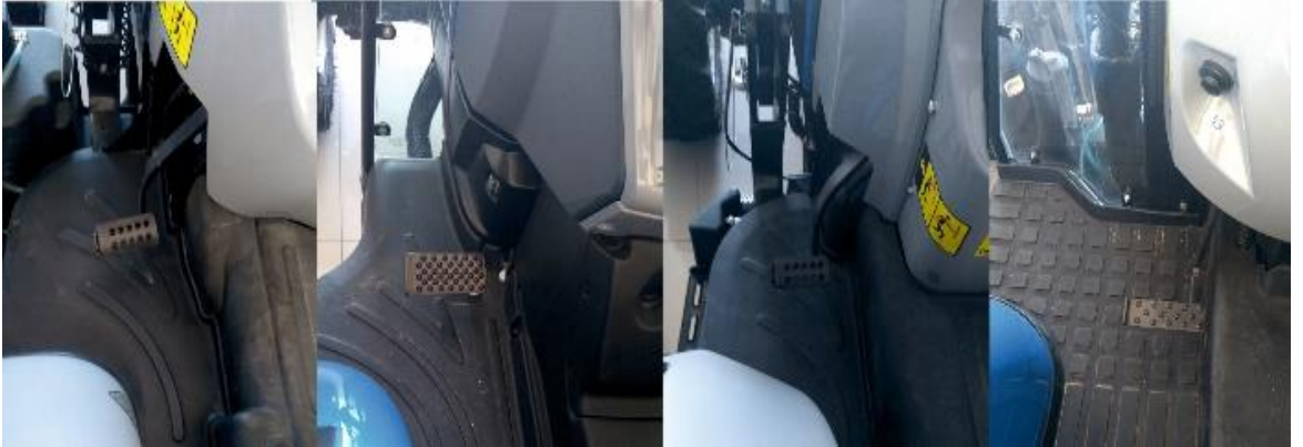
Şekil 4.1. TRA Traktörlerine ait kavrama pedalları
