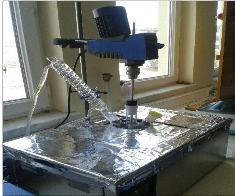
Şekil 3.1. Liç çalışmalarında kullanılan deneysel düzenek
