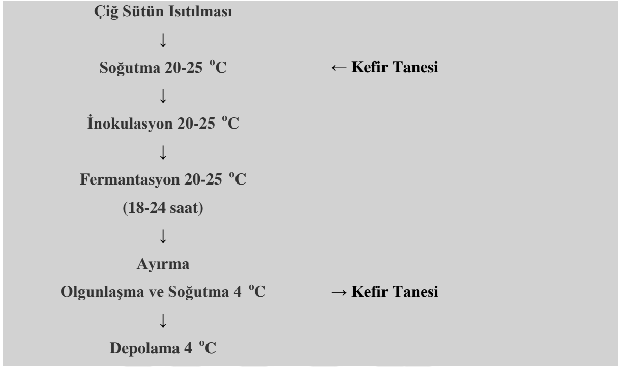
Şekil 2.4. Kefirin Geleneksel Yöntemle Üretimi
