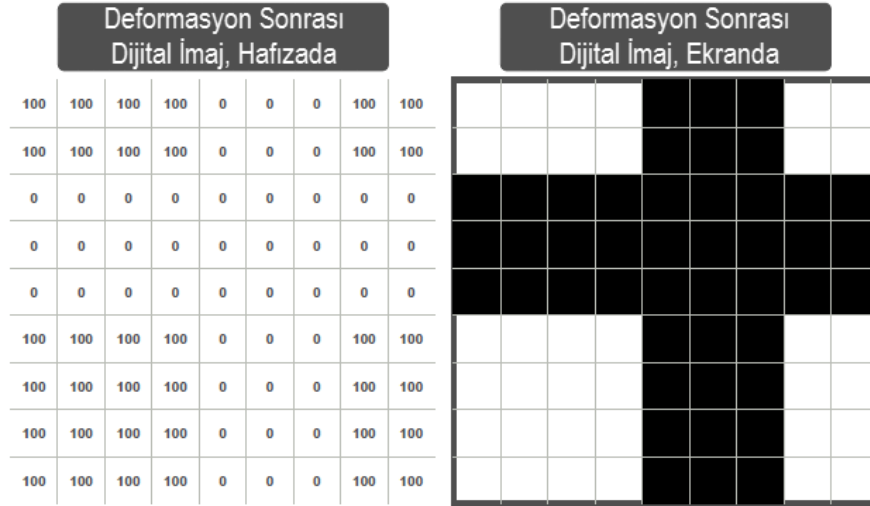
Şekil 2.26. Deformasyon sonrasındaki dijital imaj [15].
