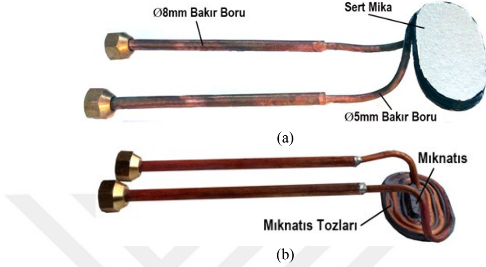
Şekil 3.8. İndüktör tasarımı. a) indüktör üst görünüş, b) alt görünüş.
