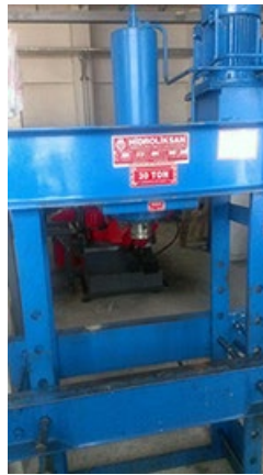
Şekil 3.26. 30 ton atölye tipi hidrolik pres.
