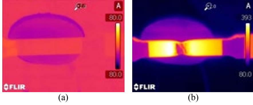
Şekil 3.10. Termal kamera ölçümü. a) oda sıcaklığında, b) yüksek sıcaklıkta.
