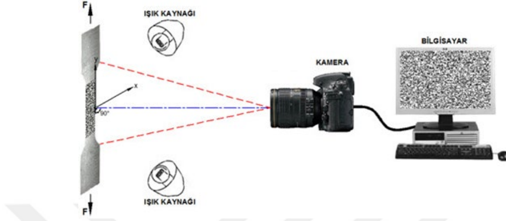
Şekil 3.12. 2B DİK yönteminin şematik resmi.
