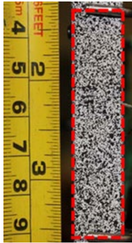
Şekil 3.18. 2B DİK yöntemi için kalibrasyon uygulaması [55].
