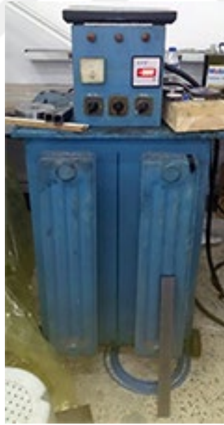
Şekil 3.27. Elektrik kaynağı trafo.
