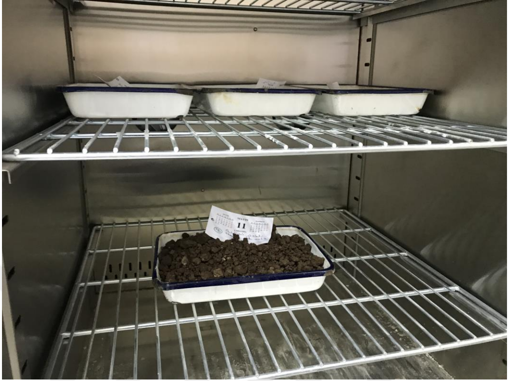
Şekil 3.8. Etüvde kurutulan kil numuneler
