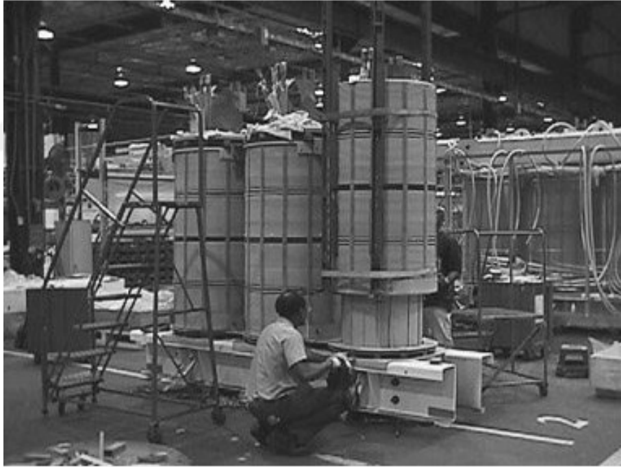
Şekil 3.1: Çekirdek-biçimli transformatörlerde, sarımların eş merkezli düzenlenmesi[14].
