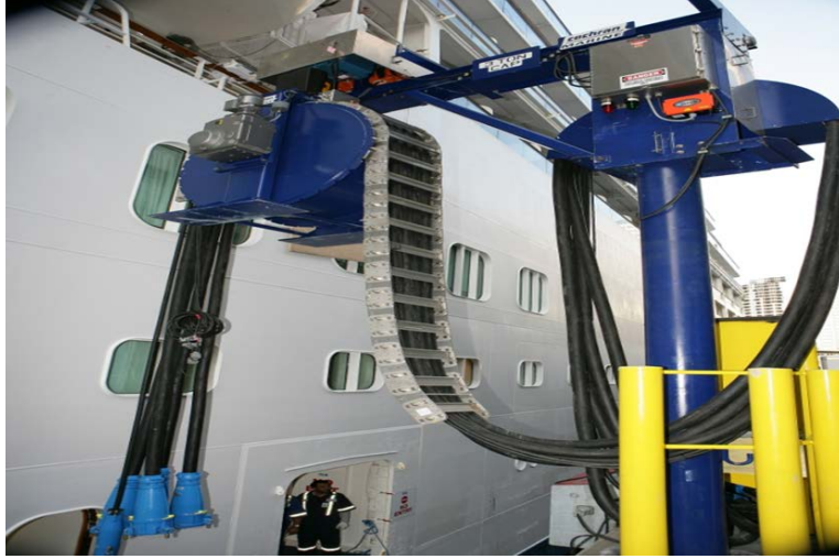
Şekil 2.1 : Otomatik sahil güç kaynağı kablo konumlandırma makinesi [21].
