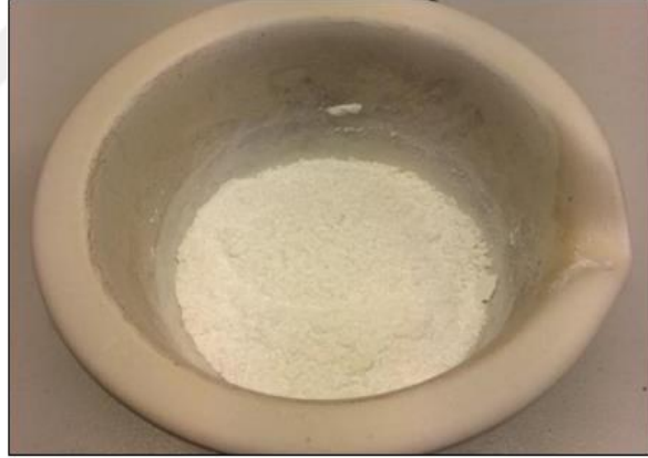
Şekil 2.2. Kalsinasyon işlemi sonrası atık yumurta kabuğu (900 ° C'de 3 sa)
