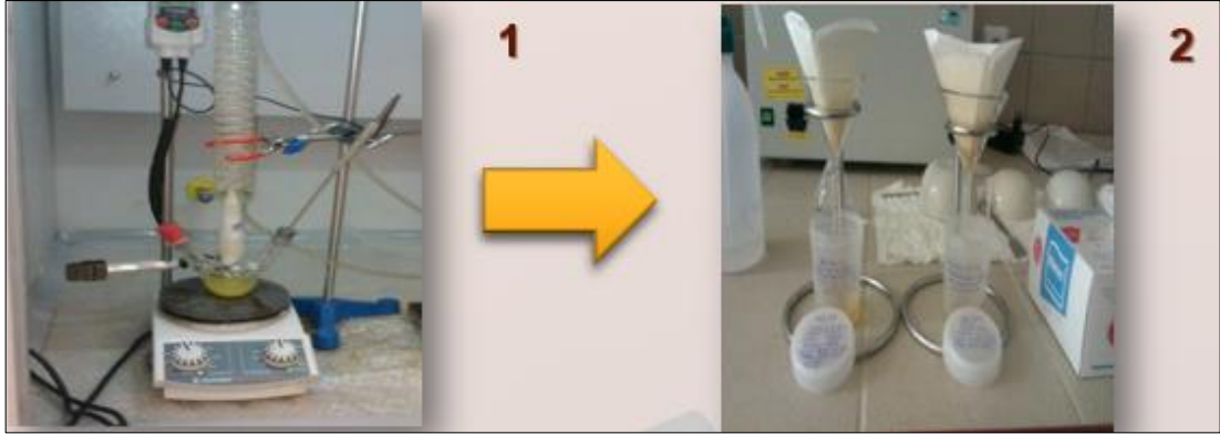
Şekil 2.3. DeneySEL biyodizel üretim düzeneđi (1. Reaksiyon düzeneđi, 2. Süzme düzeneđi)
