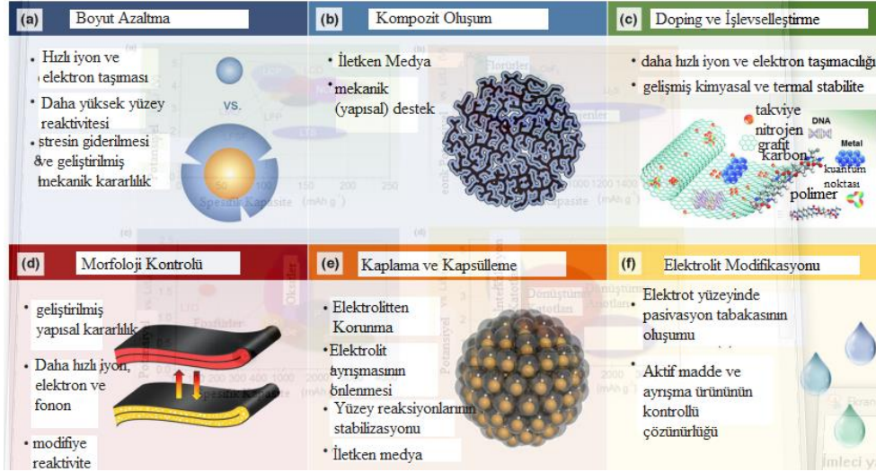
Şekil 1.8. Performans geliştirme için genel stratejiler ve gerekçeleri: (a) aktif malzemelerin boyutlarının azaltılması, (b) kompozitlerin oluşumu, (c) doping ve fonksiyonelleştirme, (d) parçacık morfolojisi ayarlama, (e) aktif malzemelerin etrafında kaplama veya kabukların oluşumu, (f) elektrolitin modifikasyonu.
