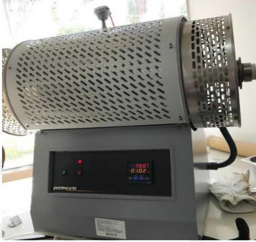
Şekil 2.2. Peletlerin 750 0 C sıcaklıkta 24 saatlik ısıl işleme tabi tutulduğu yüksek sıcaklık fırını
