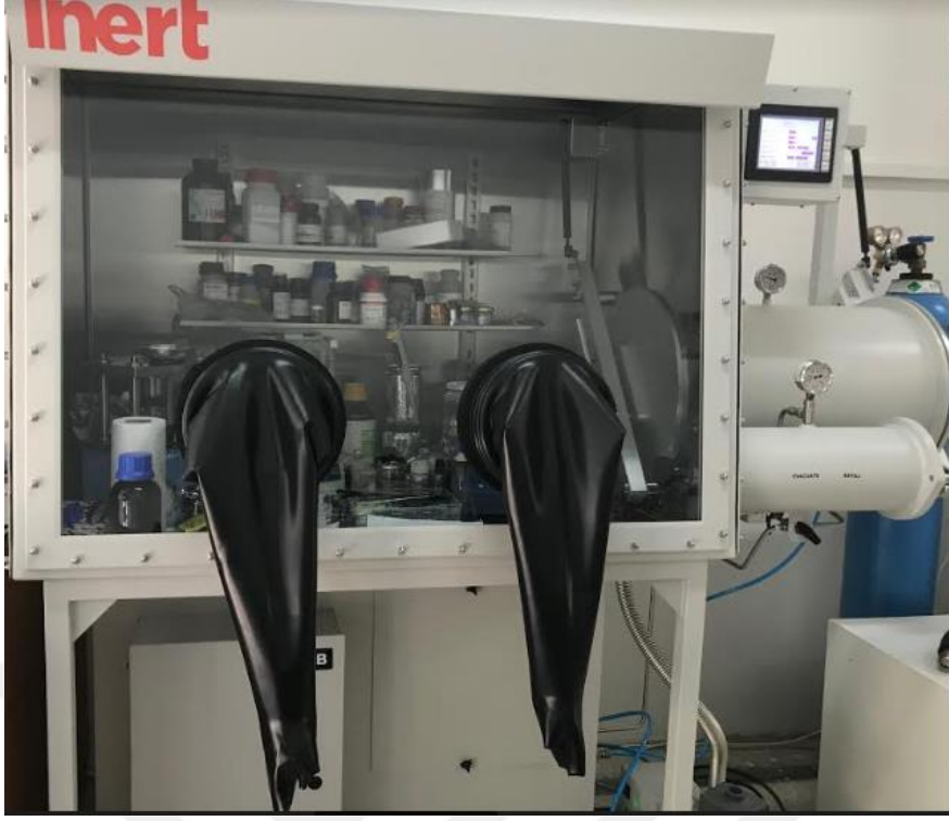
Şekil 2.8. Pil çalışması sırasında kullanılan glove-box sistemi.
