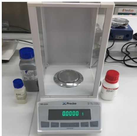
Şekil 3. 2 Hassas terazide toz tartımı ve agat havan içerisinde tozun karşılaştırılması
