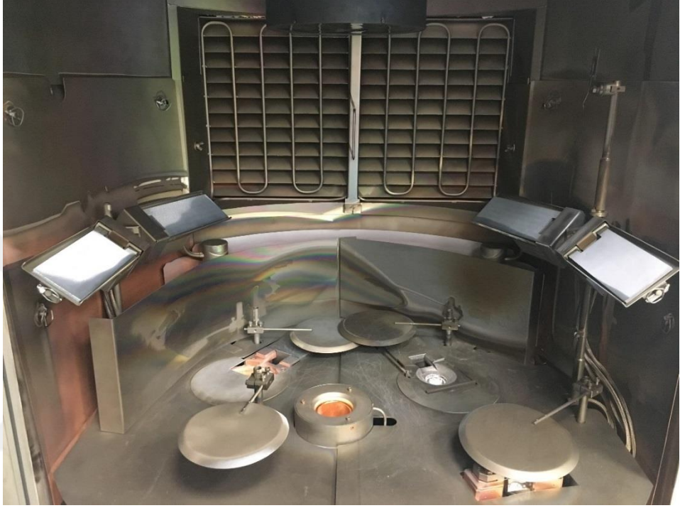
Şekil 3.24. MWIR ARC kaplamaların geliştirilmesinde kullanılan IAD sisteminin proses haznesi
