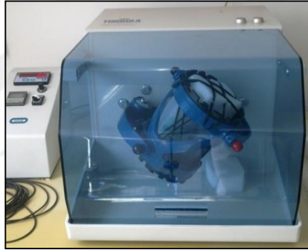
Şekil 5.4. Turbula Shaker Mixer (Model T2F Glenn Mills) tipi karıştırıcı.
