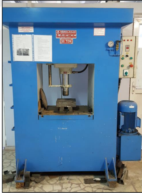
Şekil 5.6. Tek eksenli 50 ton kapasiteli Hidroliksan marka pres.
