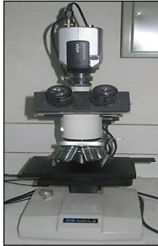
Şekil 5.2. MEIJI ML 7100 marka optik mikroskop cihazı.
