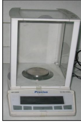
Şekil 5.3. Precisa XB220A marka hassas tartı.
