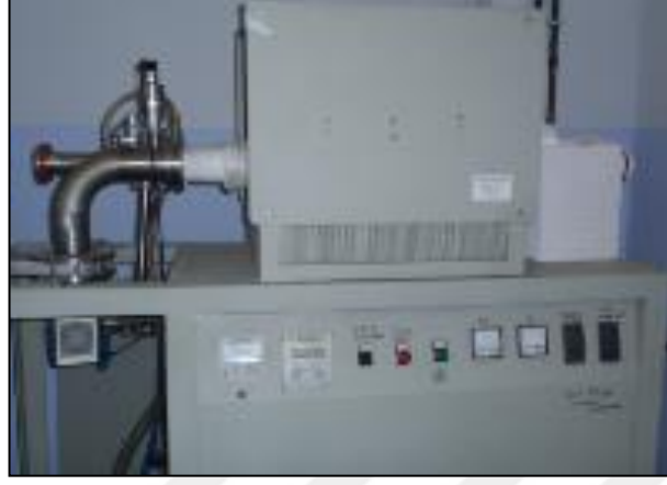
Şekil 5.7. Thermal Technology GMBH marka ısıtma fırını.
