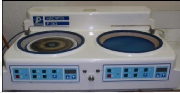
Şekil 5.1. Presi Mecapol P262 marka polisaj cihazı.
