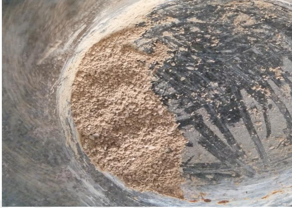
Şekil 2.2. Nano seryum oksidin fiziksel görünümü.
