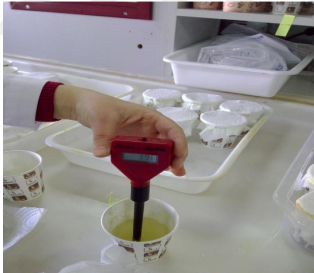
Şekil 3.4. P. expansum fungusunun PDB ortamında pH metre ile pH değeri ölçümü
