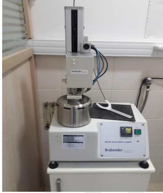
Şekil 3. 1. Brabender mikro visko amilograf cihazı
