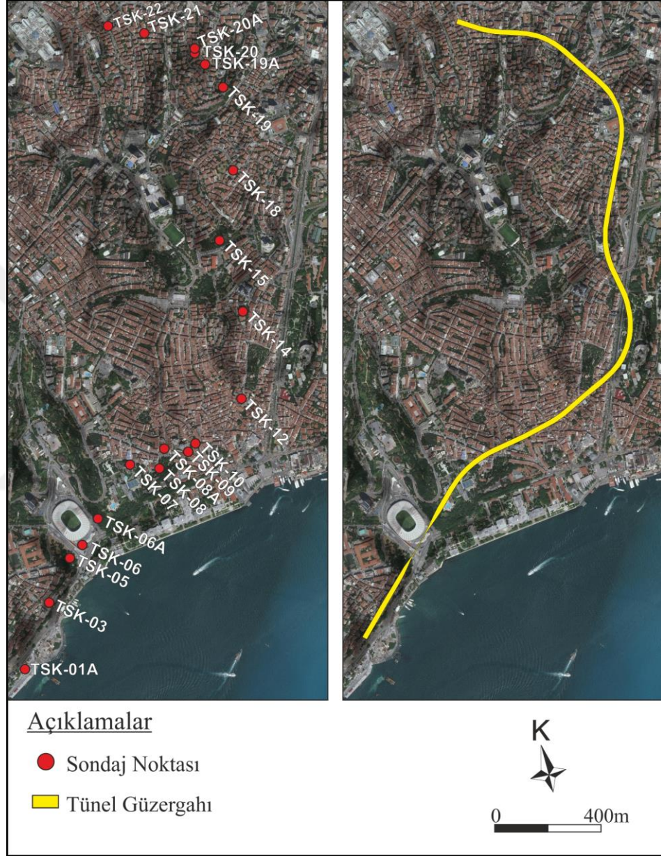
Şekil 1.1. Çalışma alanının üzerinde, temel sondaj noktaları ve tünel güzergâhı lokasyonunun gösterilmesi.
