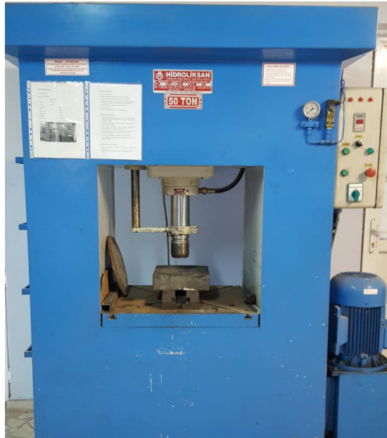
Şekil 5.4. Tozların şekillendirilmesinde kullanılan pres.
