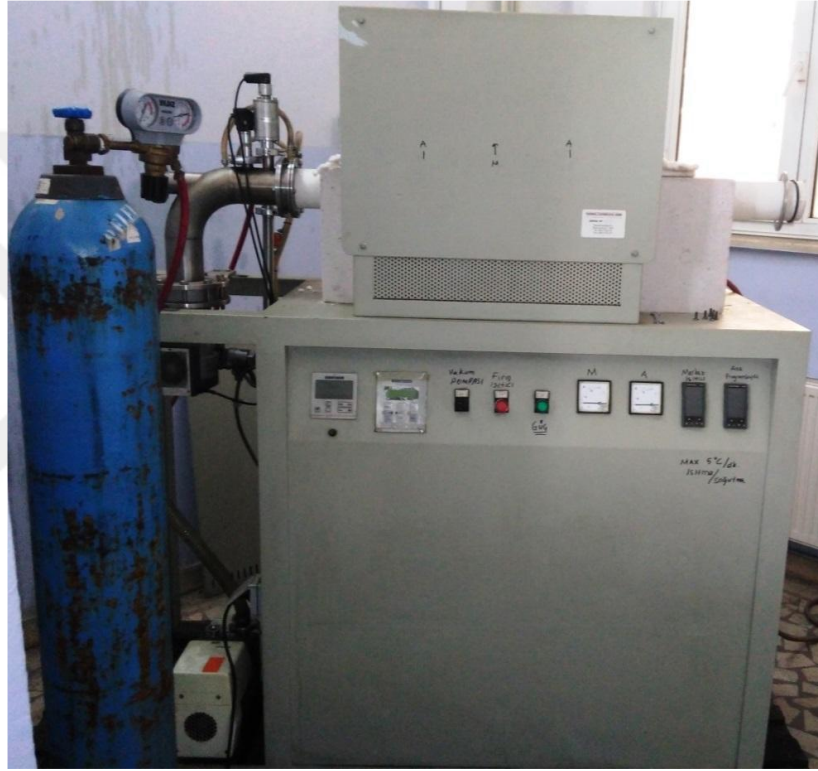
Şekil 5.5. Sinterleme işlemlerinin yapıldığı vakumlu ısıtma fırınının görüntüsü.
