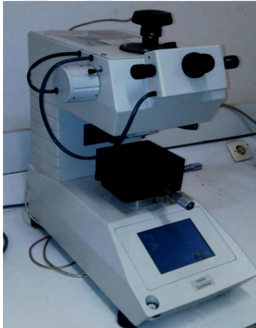
Şekil 5.6. Sertlik ölçümlerinin yapıldığı mikro sertlik cihazının görüntüsü.
