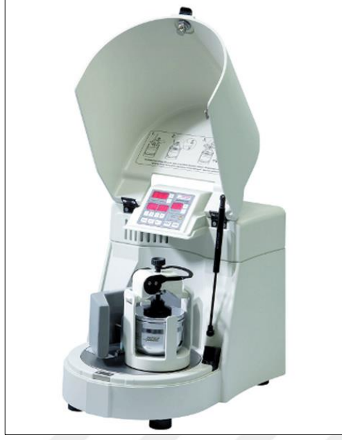
Şekil 5.2. Mekanik alaşımlama/öğütme cihazı.
