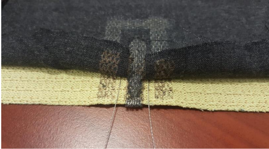
Şekil 4.10 : Aramid/viskoz bazlı kumaşın ultrasonik kaynak dikiş işlemi sonrasında zedelenmesi.
