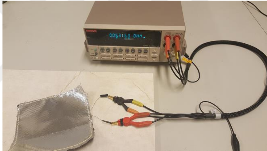
Şekil 4.17 : 4-prob yöntemi kullanarak multimetre ile iletken ipliğin lineer direnç değerlerinin ölçülmesi.
