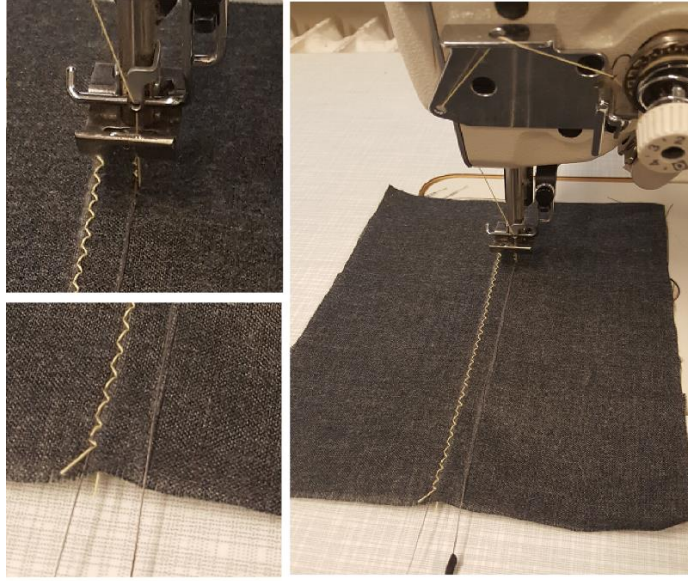
Şekil 4.12 : Zigzag dikiş makinesi kullanılarak iletken ipliğin astar kumaşa sabitlenmesi.
