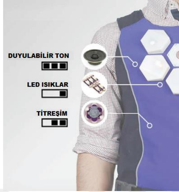
Şekil 2.11 : E-SEWT projesinde sesli, görsel ve dokunsal uyarı sistemlerinin tekstil yapısına yerleşimi [37].
