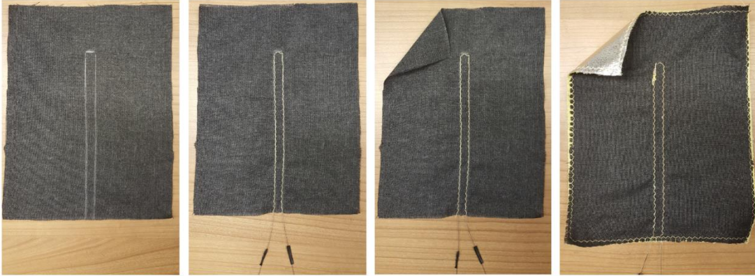
Şekil 4.13 : Konvansiyonel dikiş tekniğiyle e-tekstil yapısı oluşturma aşamaları.
