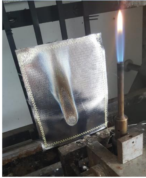
Şekil 4.7 : Sınırlandırılmış alev sıçraması testi Prosedür A'ya göre numunenin test edilmesi.
