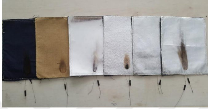
Şekil 5.1 : Sınırlandırılmış alev sıçraması testi sonucunda kumaşta meydana gelen kömürleşme.
