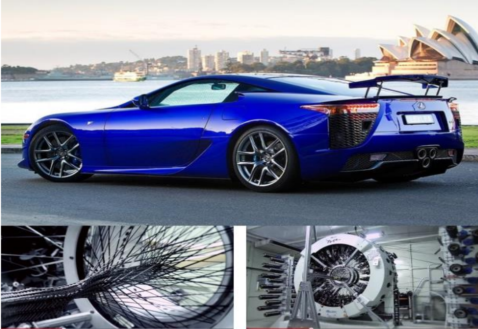
Şekil 3.6. Spor otomobil parçalarının karbon lifinden hazırlanması [55].
