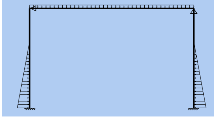
Şekil 4.21 : Yayılı yükleri eklenmiş kiriş sisteminin görünüşü.
