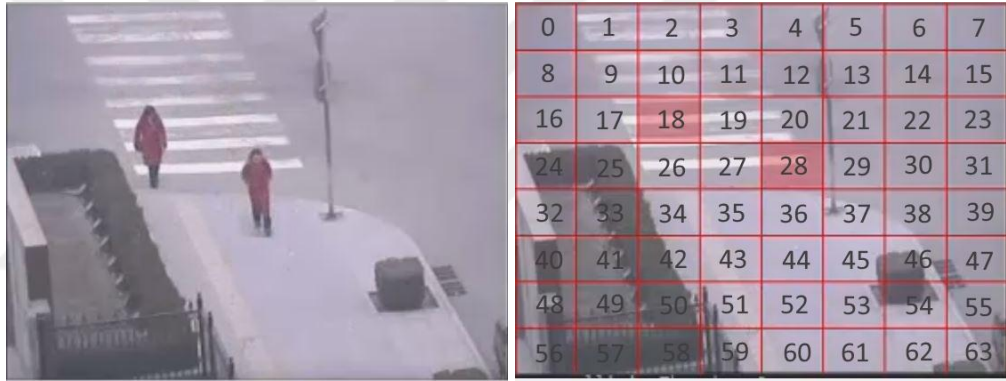
Şekil 3.11 Görüntünün gridlere bölünmesi
