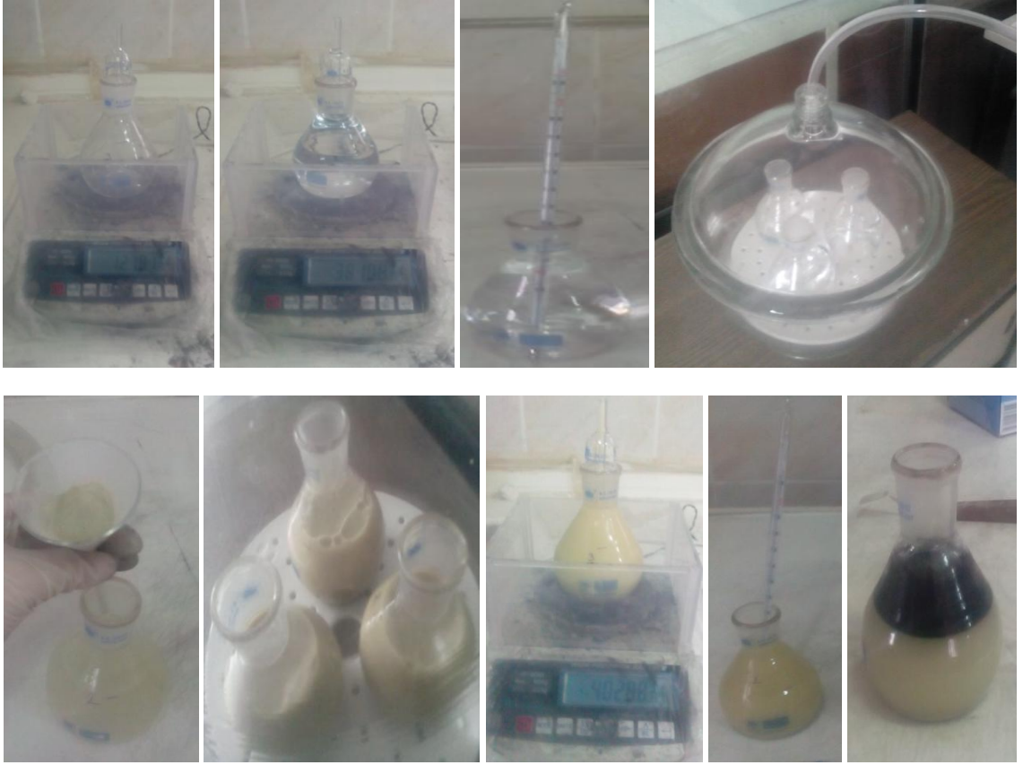
Şekil 3.6. Özgül ağırlık deneyi aşamaları
