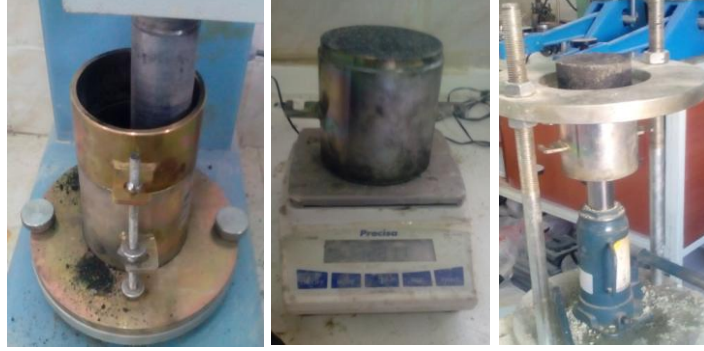
Şekil 3.12. Standart kompaksiyon deneyi
