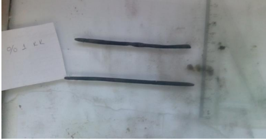
Şekil 3.9. Plastik limit deneyi
