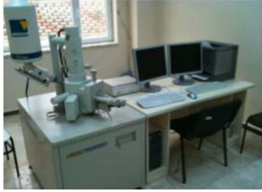
Şekil 5.2. Sakarya Üniversitesi, Mühendislik Fakültesi, Metalurji ve Malzeme Mühendisliği Bölümü laboratuvarında bulunan SEM cihazı
