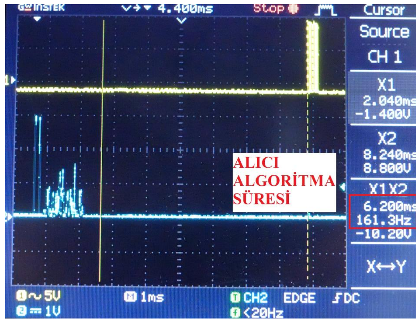
Şekil 4.12: Alıcı devrede alınan verinin işlenip seri porta gönderilme süresi.
