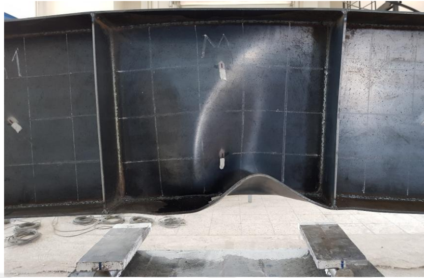
Şekil 3.26. Tip1-500 kirişi deney sonrası deformasyon görüntüsü(arka tarafı)
