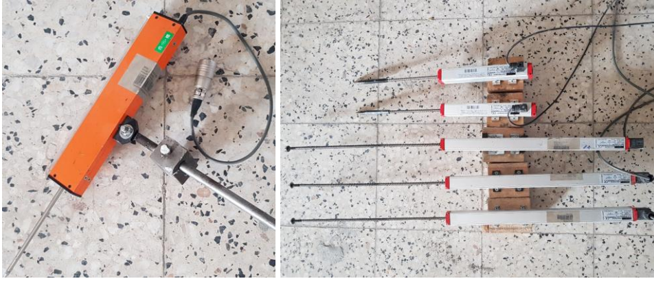
Şekil 2.13. LVDT ve Potansiyometrik cetvel
