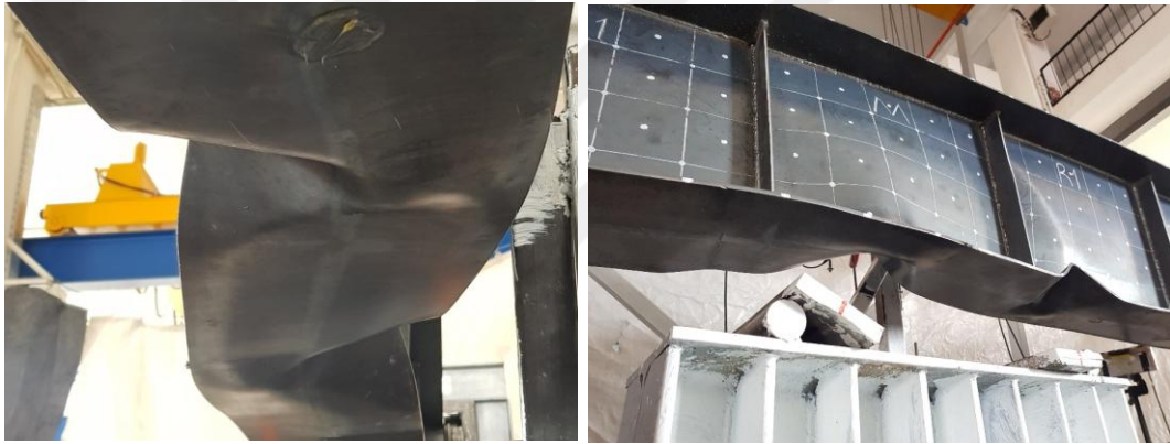
Şekil 3.55. Tip2-500 Kirişi deney sonrası deformasyon görüntüsü (alt tarafı)
