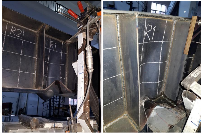
Şekil 3.39. Tip1-250 Kirişi deney sonrası deformasyon görüntüleri (arka tarafı)
