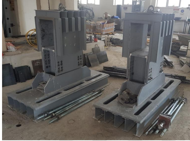
Şekil 2.10. Kiriş ankastre mesnetleri için çelik düzenekler
