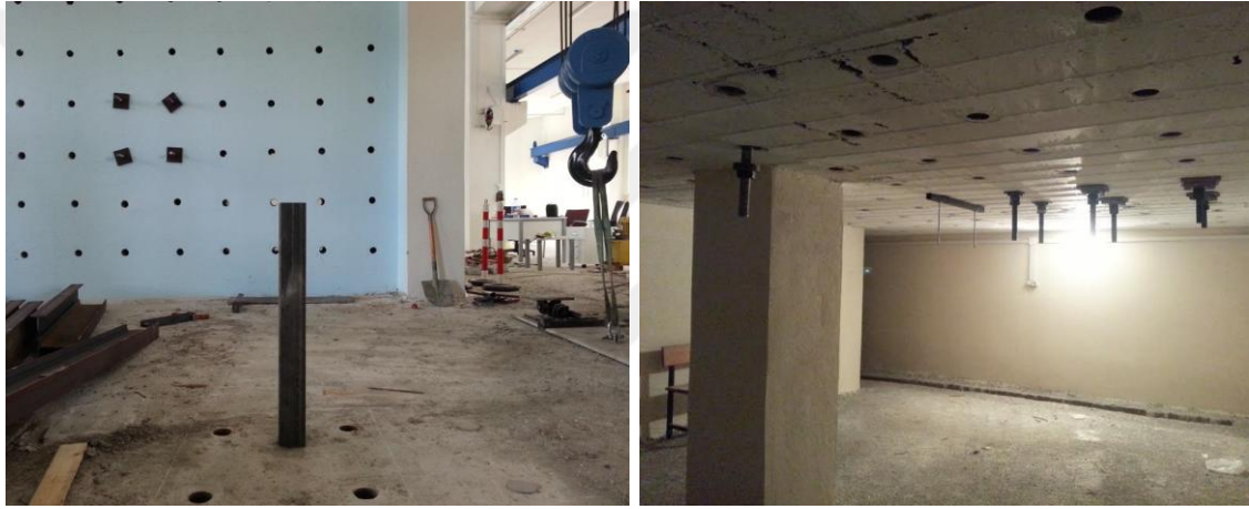
Şekil 2.2. Yükleme duvarı ve rijit platform
