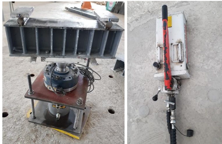
Şekil 2.11. Yükleme kirişi, loadcell, hidrolik kriko düzeneği ve manuel el pompası
