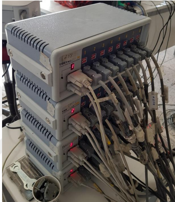
Şekil 2.17. Yarı Statik Veri Toplama Cihazları
