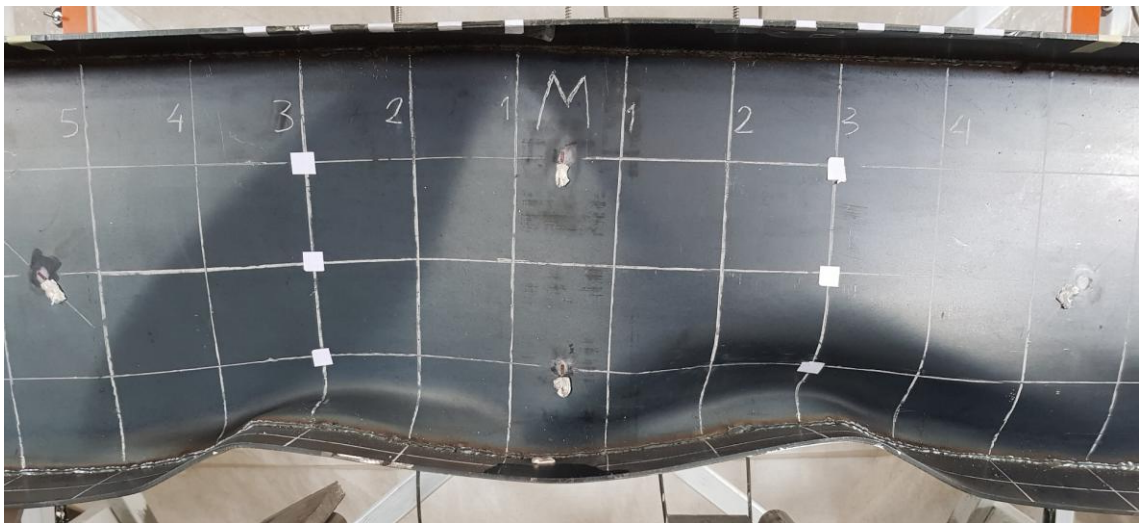
Şekil 3.7. Referans kiriş deney sonrası deformasyon görüntüsü (ön tarafı)
