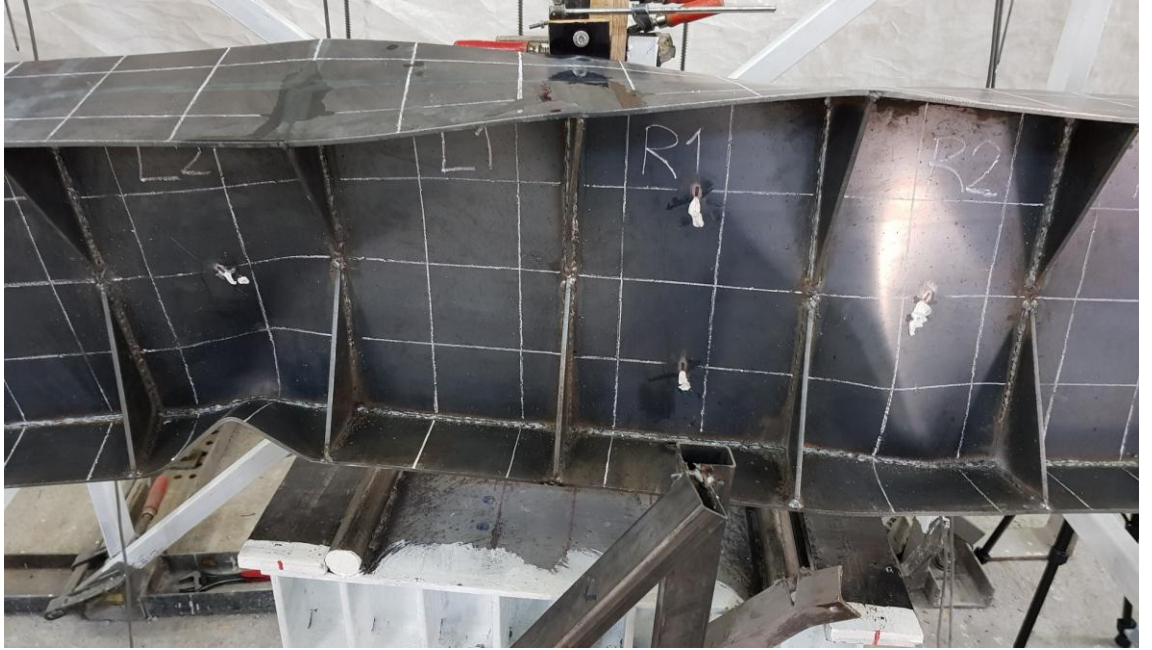
Şekil 3.92. Tip3-250 Kirişi deney sonrası deformasyon görüntüsü(ön tarafı)
