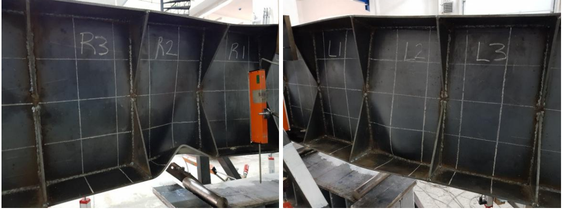
Şekil 3.93. Tip3-250 kirişi deney sonrası deformasyon görüntüsü(arka tarafı)
