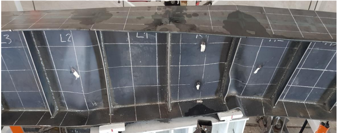
Şekil 3.65. Tip2-250 Kirişi deney sonrası deformasyon görüntüsü (ön tarafı)
