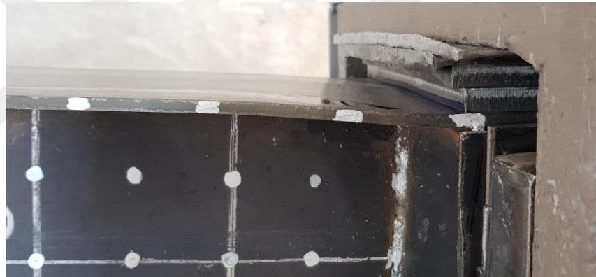
Şekil 3.24. Tip1-500 kirişi deney sonrası deformasyon görüntüsü (mesnet üst flanş)
