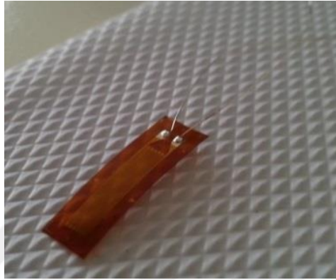
Şekil 2.19. Gerinim pulu (Strain Gauge)
