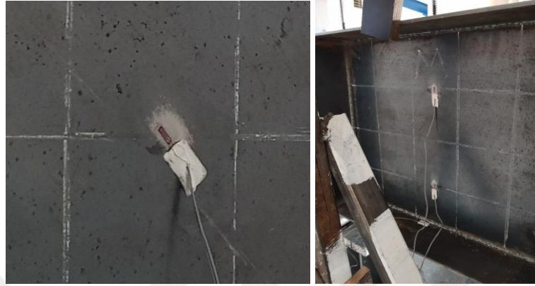
Şekil 2.24. Gerinim ölçer yapıştırılmış yüzey görüntüleri
