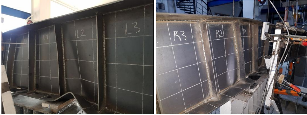
Şekil 3.66. Tip2-250 Kirişi deney sonrası deformasyonu görüntüsü (arka tarafı)
