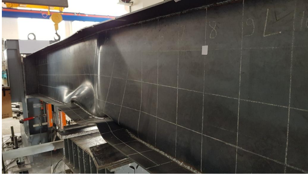
Şekil 3.8. Referans kiriş deney sonrası deformasyon görüntüsü (arka tarafı)
