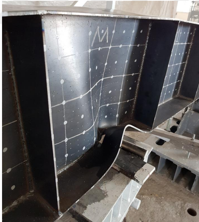
Şekil 3.20. Tip1-500 kirişi deney sonrası deformasyon görüntüsü (ön tarafı)
