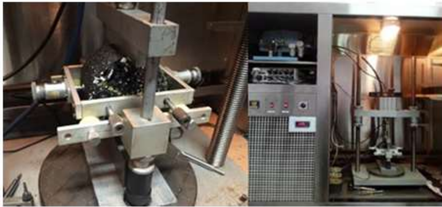
Şekil 3.12. İklimlendirme kabini ve indirekt çekme rijitlik modülü deney düzeneği
