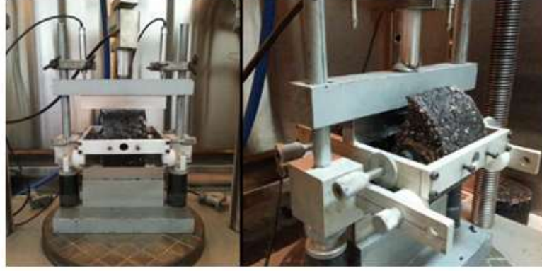
Şekil 3.14. İndirekt çekme yorulma deney düzeneği
