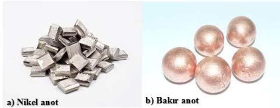
Şekil 4.4. Nikel ve Bakır anotlar
