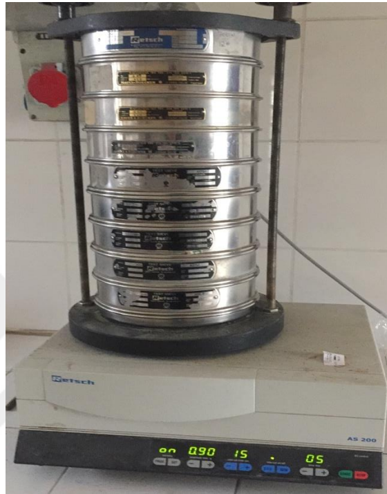
Şekil 4.10. Laboratuvar ölçekli titreşimli elek
