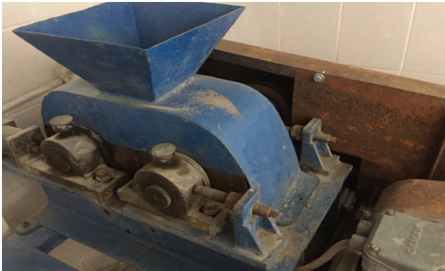
ekil 4.9. Laboratuvar lekli merdaneli krc
