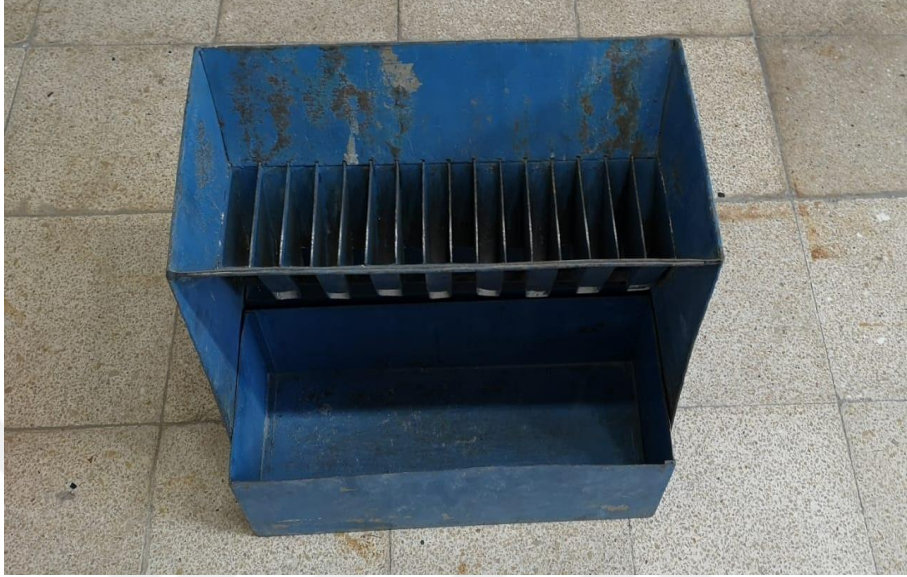
ekil 4.8. On alt blmeli numune blc
