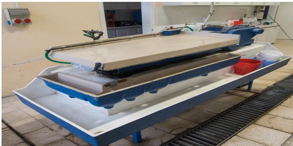
Şekil 4.11. Wilfley laboratuvar ölçekli sallantılı masa
