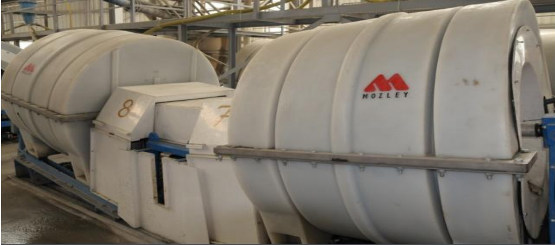
Şekil 2.6. Mozley Multi Gravite ayırıcı (Kıdıman, 2009)
