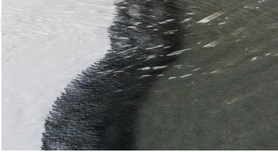
Şekil 4.12 Wilfley laboratuvar ölçekli sallantılı masa ile yapılan zenginleştirme deneyleri
