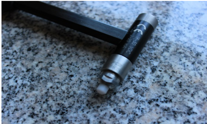
Şekil 3.17. PCB 086C01 darbe çekici
