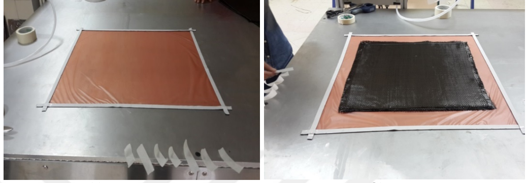
Şekil 3.1. Release(ayırma) film kumaşı ve sızdırmazlığın sağlanması (a) ve 5 kat dokunmuş karbon elyaf kumaşının release film üzerine serilmiş hali (b)
